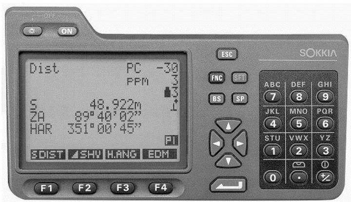
Fig. 27: Pantalla digital y teclado de una estación total. Fuente: http://www.sokkia.com
