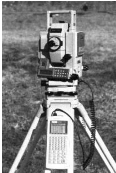
Fig. 32: Estación total con colector externo situado sobre el trípode. Fuente: http://www.sokkia.com
