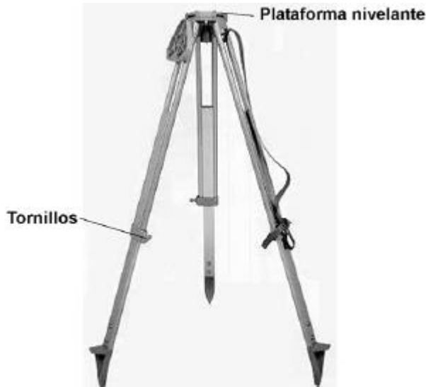
Fig. 35: Trípode típico utilizado para los trabajos topográficos. Fuente: http://www.sokkia.com
