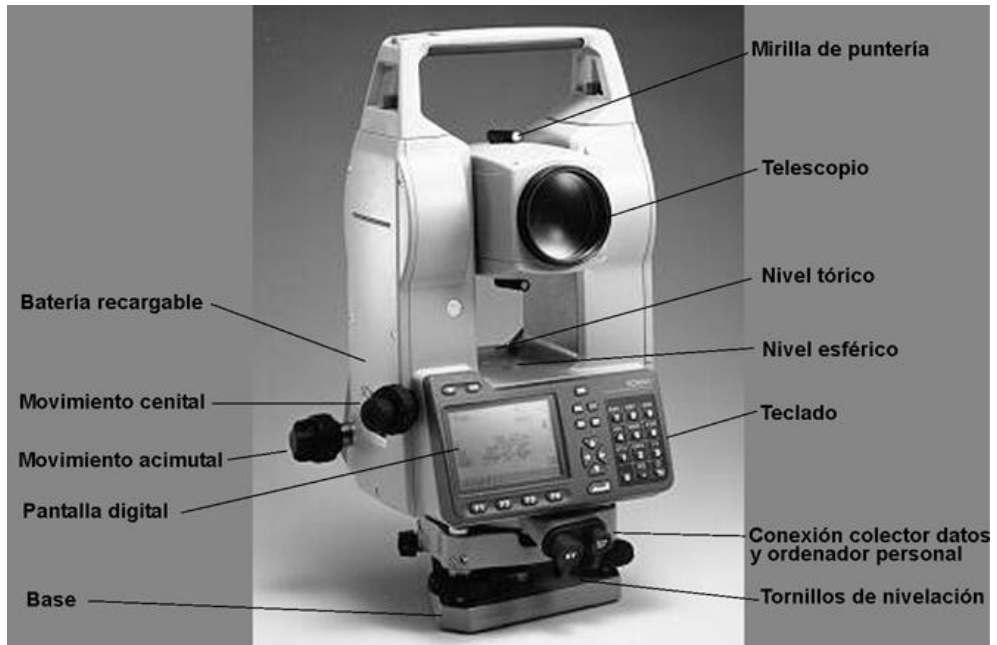
Fig. 26: Partes fundamentales de una estación total. Fuente: http://www.sokkia.com
