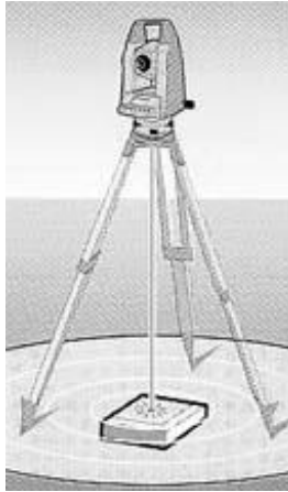
Fig. 34: Estación total equipada con plomada láser. Fuente: http://www. leica.com
